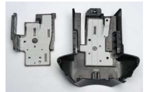
Crash Pad con inserto metálico
