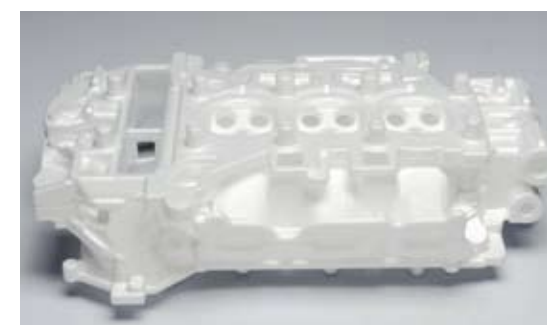
Elemento espumado de culata
